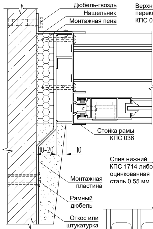
Вариант монтажа с помощью монтажных пластин
