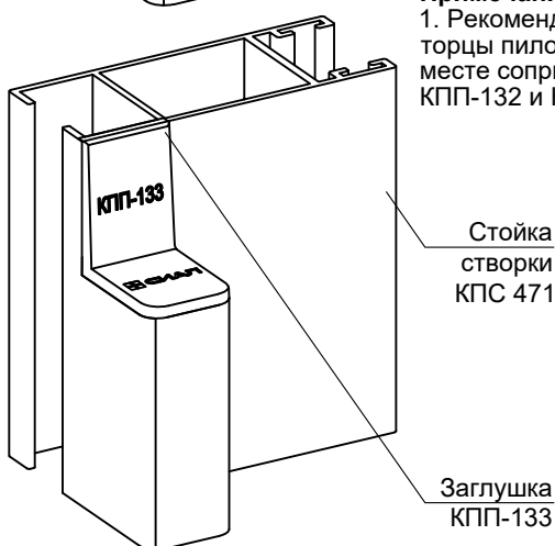
Обработка стойки КПС 471 под заглушки КПП-133
